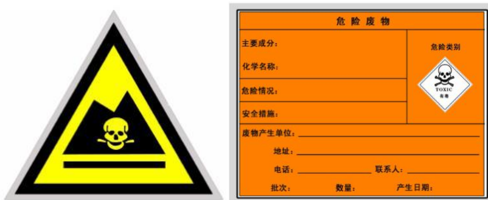
图 10-4 危险废物警告标志牌、危险废物标签
