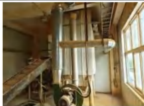
邻氯甲苯车间废气处理装置
