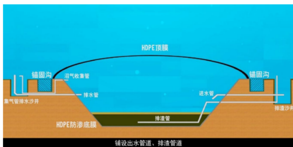
图 3.3.2-4 黑膜沼气池结构示意图
