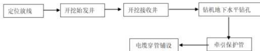
图 2.3-2 定向开挖工艺流程图
