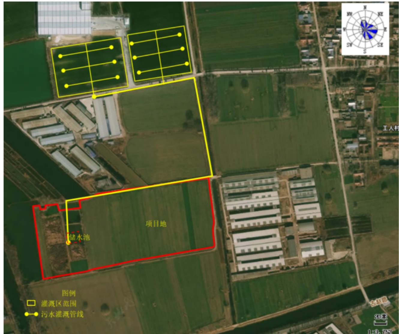
图 6.2-3 本项目废水输送管线图
