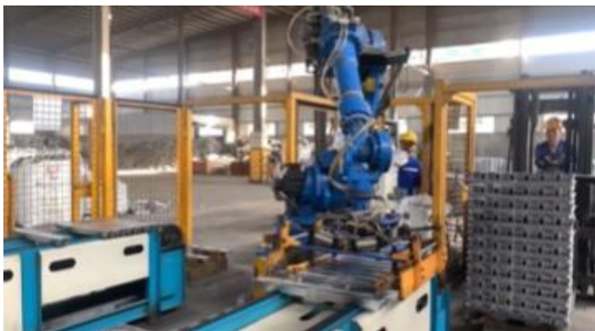
图 3-1 机械臂叠锭示意图
