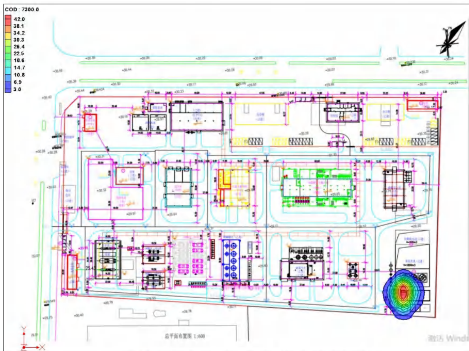
图 5.6.3-6 非正常工况下污水处理站调节池 COD_{Mn} 7300d 运移图
