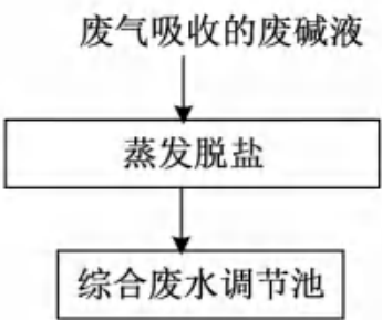
图 6.2.2-1 蒸发脱盐处理工艺流程图
