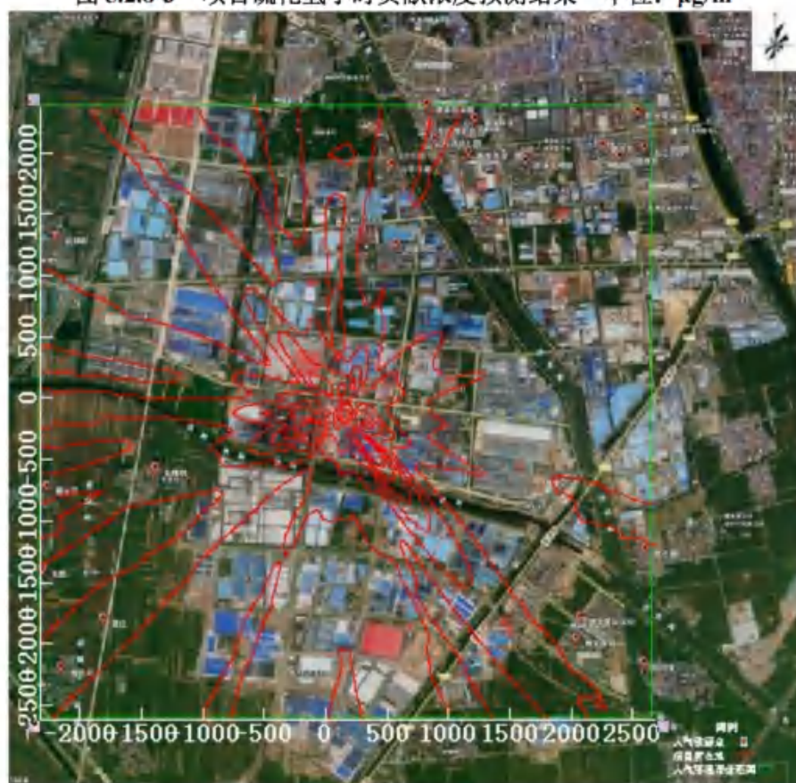
图 5.2.8-4 项目 \text{PM}_{10} 日平均贡献浓度预测结果 单位: \mu\text{g}/\text{m}^3
