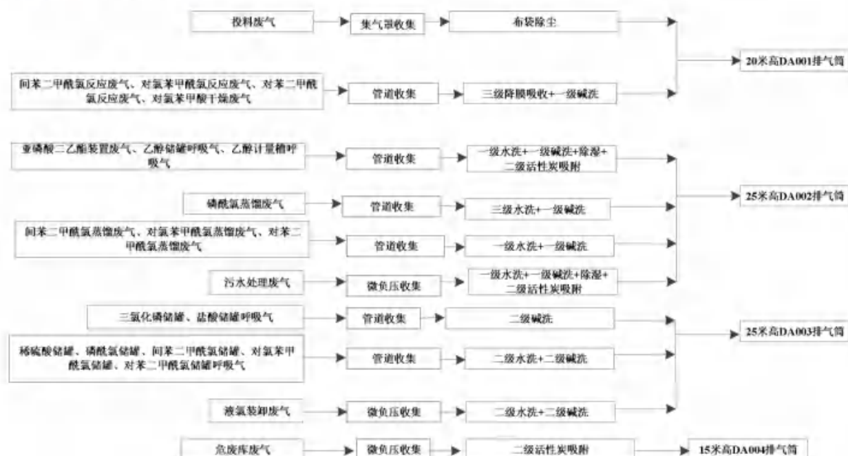
图 6.1.1-1 本项目废气收集处理情况图
