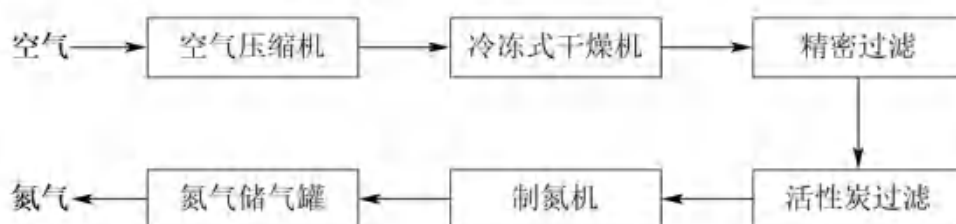
图 4.1-2 项目制氮机制氮工艺流程图
