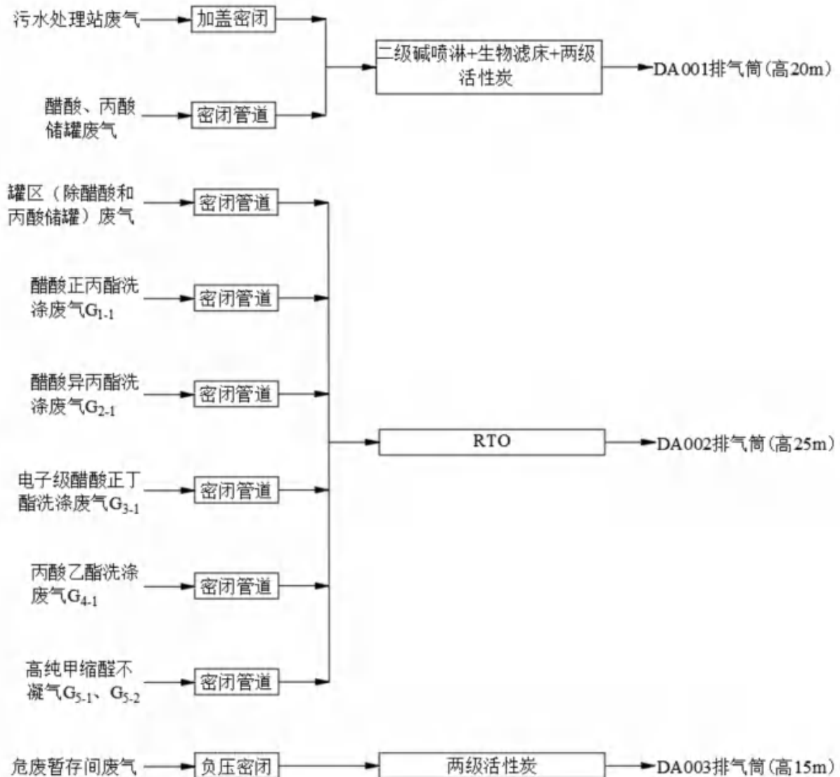
图 6.1.1-1 本项目废气收集处理工艺示意图
