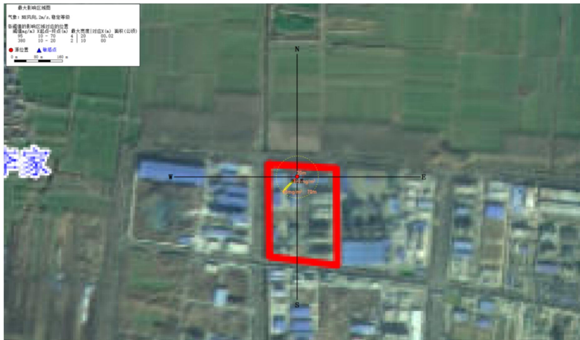
图 5.7.6-3 最不利气象条件下薄膜溶剂储罐泄露次生 CO 事故最大影响范围示意图
