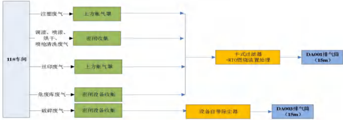
图 6.1.1-1 本项目废气治理措施示意图
