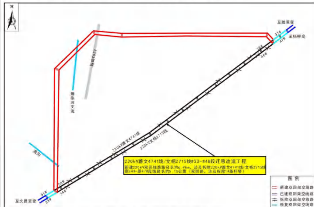
图 2-1 本项目接线及重要跨越示意图
