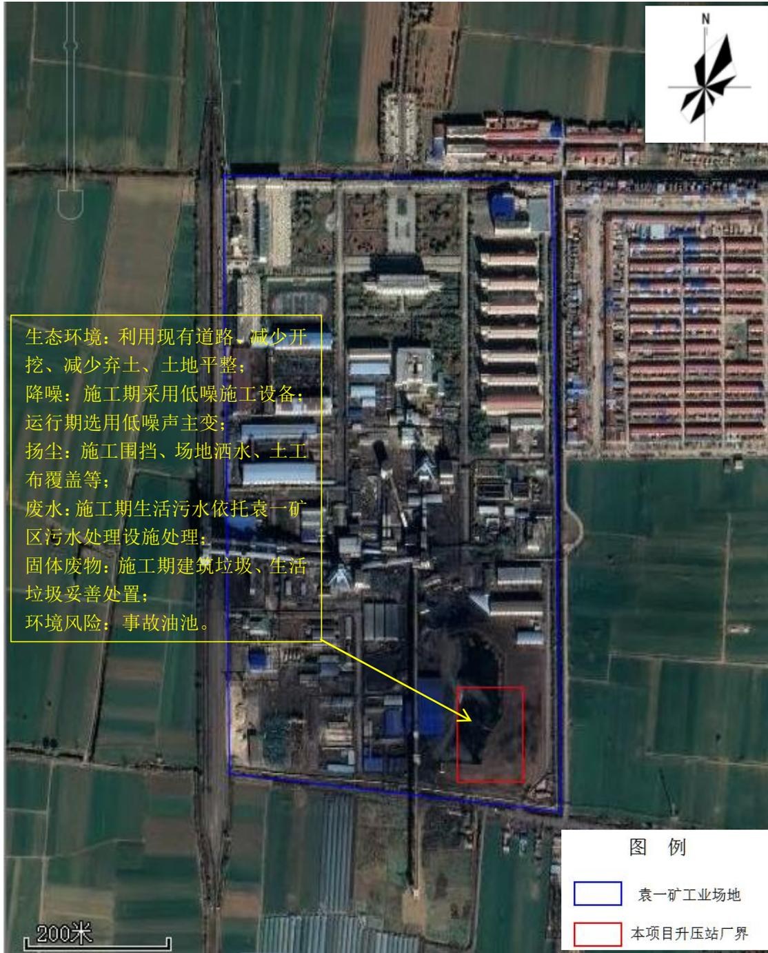
附图 8 本项目生态保护措施平面布置示意图
